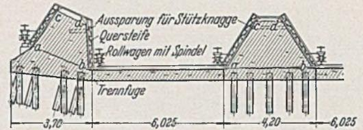
Abb. 2. Schalungskonstruktion für Widerlager und Mittelpfeiler.
