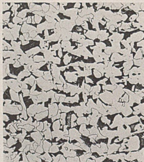
Abb. 9. Gefüge des Werkstoffs des Probekörpers 48 809 c. 1 K. (St 52 P, Walzzustand.) Nutschweißbiegeprobe: t = \text{rd. } 50 \text{ mm} , l = 6 t + 100 \text{ mm} , \alpha_R = 10^\circ , \alpha = 21^\circ .
