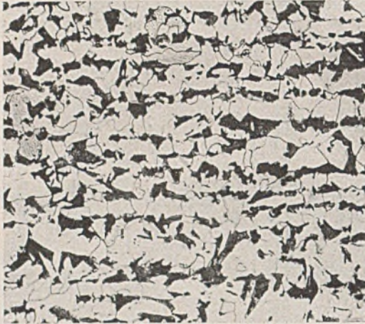
Abb. 4. Gefüge des Werkstoffs des Probekörpers 106 801. E 1. (St. 52 unlegiert, ohne Al, GH1.) Nutschweißbiegeprobe: t = \text{rd. } 50 \text{ mm} , l = 6 t + 100 \text{ mm} , \alpha_R = 8^\circ , \alpha = 14^\circ .
