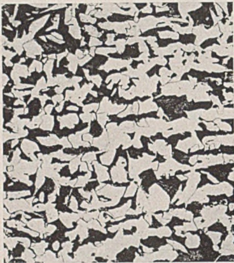
Abb. 6. Gefüge des Werkstoffs des Probekörpers 48808 b. 3 K. (St 52 P, Walzzustand.) Nutschweißbiegeprobe: t = \text{rd. } 50 \text{ mm} , l = 6 t + 100 \text{ mm} , \alpha_R = 9,5^\circ , \alpha = 9,5^\circ .
