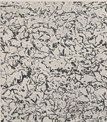
Abb. 8. Gefüge des Werkstoffs des Probekörpers 48 809 a. 4 KN. (St 52 P, mit Al, normalgeglüht.) Nutschweißbiegeprobe: t = \text{rd. } 50 \text{ mm} , l = 6 t + 100 \text{ mm} , \alpha_R = 8^\circ , \alpha = 62^\circ .
