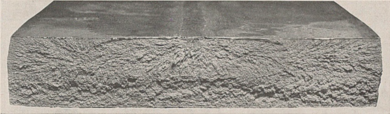
Abb. 30. Bruchfläche einer spröd gebrochenen Nutschweißbiegeprobe.
