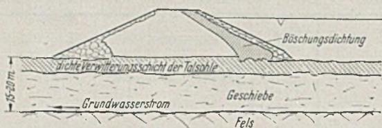
Abb. 6. Querschnitt eines Dammes mit Böschungsdichtung zur Bildung.
