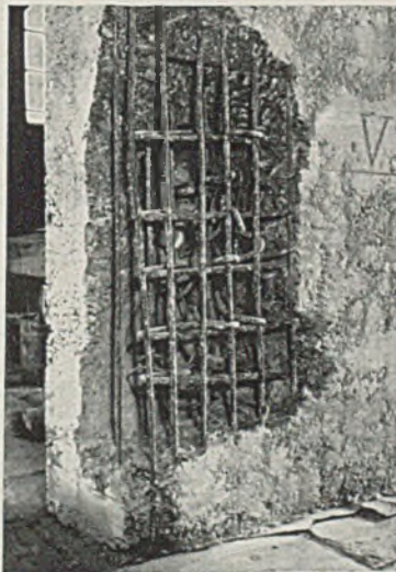
Abb. 12 und 13. Aufstimmung am Körper III (Kreidestriche: Abgerissenes Rundeisen).
