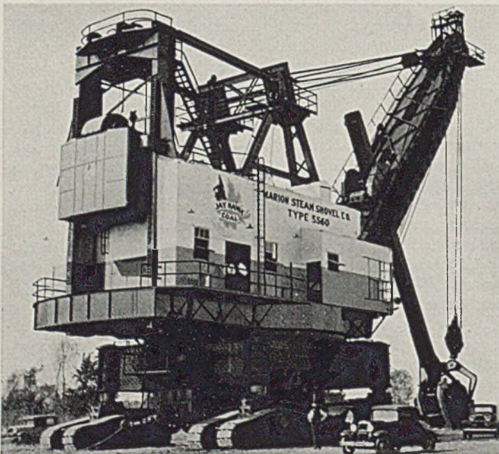
Abb. 2. Seitenansicht des Löffelbaggers „Marion 5560“ mit beweglichem Gegengewicht.
