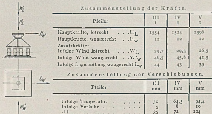
Abb. 43. Zusammenstellung der Kräfte und Verschiebungen für die am stärksten belasteten Stelzenlager auf Pfeiler III, IV, V.
