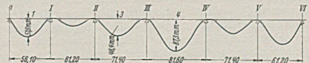
Abb. 36. Biegelinie für die ständige Last. Größte Durchbiegung in Öffnung 1 = 51,6 mm, „ „ „ 3 = 46,4 mm, „ „ „ 4 = 87,3 mm.
