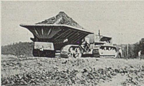
Abb. 13. Geländegängiges Fahrzeug auf Raupen mit Treckerzug.
