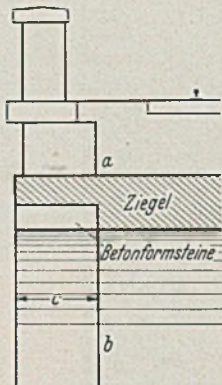
Abb. 9. Die Fuge b fördert die Stirnringabtrennung.
