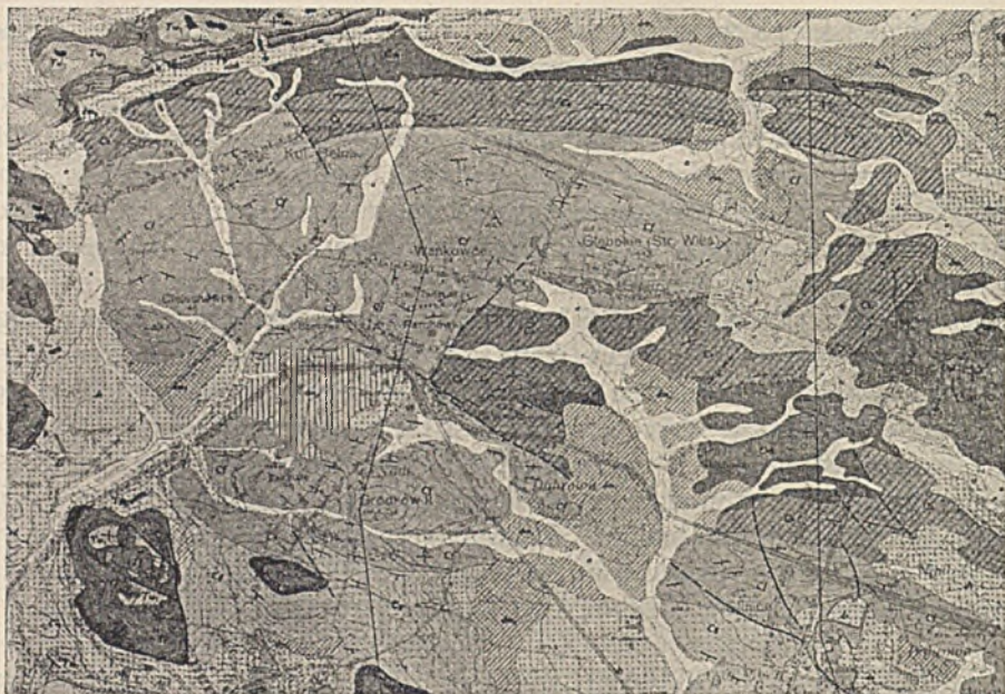
Rys. 114. Fragment mapy geologicznej śląskiego zagłębia węglowego ilustrujący zarysy terenu, który powinien być wyłączony spod zabudowy, jako przeznaczony do przyszłej eksploatacji kopalnianej.
