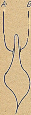
Rys. 10. Neuron realizujący operację iloczynu logicznego
