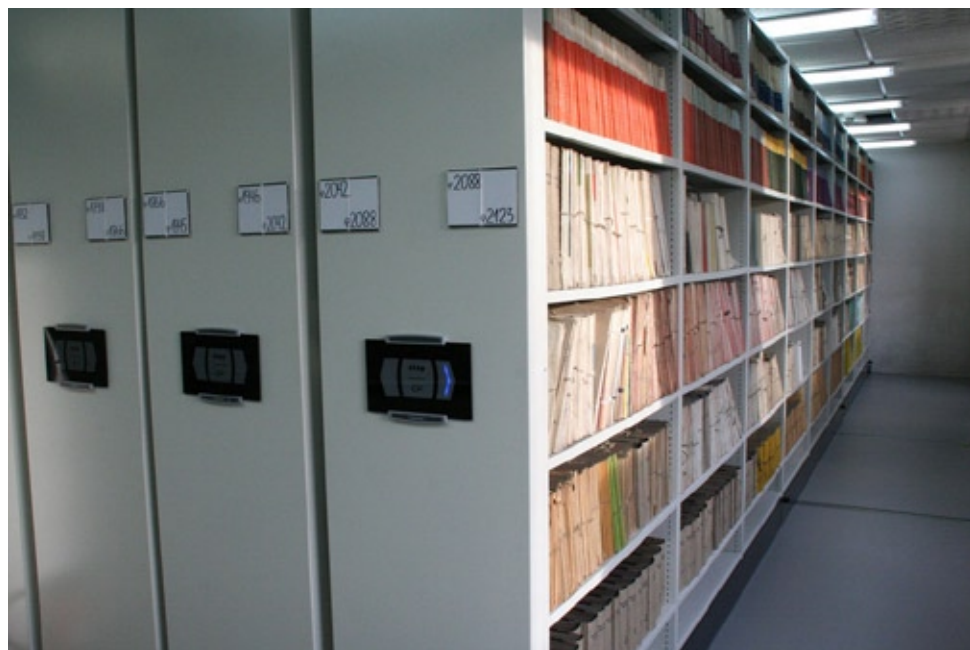
Rys. 23. Regały o długości 9 m przesuwane elektrycznie
