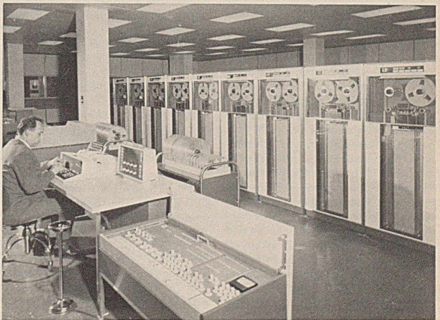
Bild 2: Steuerpult und Magnetbandspeicher der Datenverarbeitungsanlage IBM 7070.
