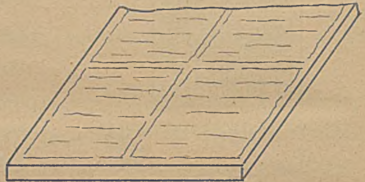
Rys 257. Część płyty Pollaka z nałożoną masą po przewalcowaniu
