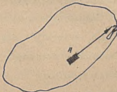
Rys. 506. Materja namagnesowana scharakteryzowana przy pomocy solenoidów elementarnych.
