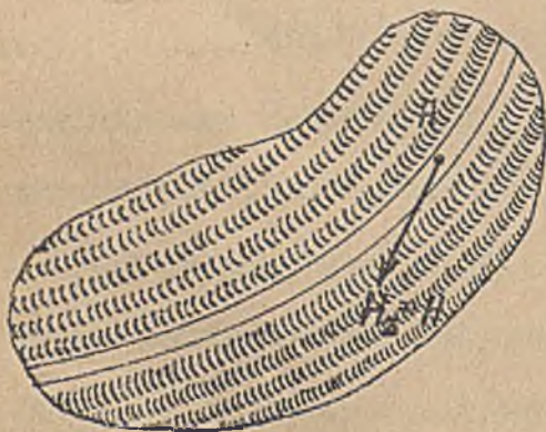
Rys. 510. Natężenie wypadkowe \mathcal{H} w kanaliczku równe natężeniu \mathcal{H}_z .
