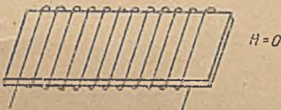
Rys.299. Płaskie uzwojenie prawie nie daje pola magnetyczn.
