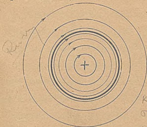
Rys. 306. Pole magnetyczne wewnątrz pełnego kołowego przewodu pod prądem o l = \infty .
