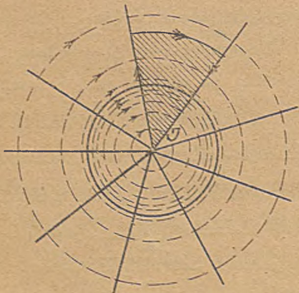
Rys.328. Powierzchnie wertykalne przewodnika pod prądem.
