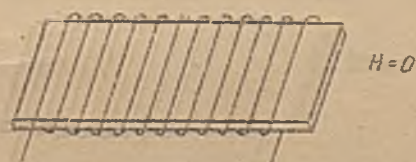
Rys. 299. Płaskie uzwojenie prawie nie daje pola magnetycznego.
