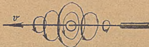
Rys. 308. Chwilowe pole ruchomego naboju ujemnego (więc także elektronu).
