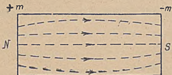
Rys.514. Linje natężenia H wewnątrz magnesu stalowego w interpretacji mas magnetycznych.
