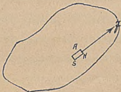
Rys. 505. Materja namagnesowana scharakteryzowana przy pomocy magnesów elementarnych.
