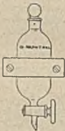
547.771.2: 664.126.531 Appareil pour l'essai du saccharose à l' \alpha -naphthol. — G. L. SPENGER. — Industr. engin. Chem. , 1923. t. 15, N° 6, p. 593, Juin.
