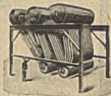
Chaudière Stirling à 6 collecteurs.
