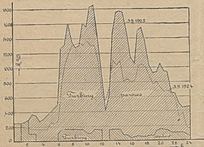
Rys. 3. Obciążenie i produkcja turbin wodnych i parowych w dniu najwyższego obciążenia w elektrowni w Stockim Młynie.
