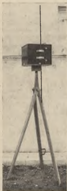
Rys. 6. Przenośny generator pomiarowy z anteną dipolową.
