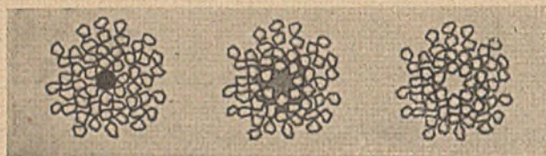
drut pary metalu skorupa Rys. 6. Schematyczny przebieg procesu gaszenia łuku w bezpieczniku.
