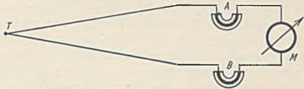
Fig. 75. Schema eines Thermoelements. ( T Lötstelle für die zu messende Temperatur, A B Quecksilbergefüße auf fester Temperatur und zur Verbindung mit dem Spannungsmesser M .)
