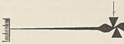
Fig. 26. Schema eines Fühlhebels.
