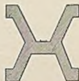
Fig. 2. Querschnitt durch das Prototypmeter, natürliche Größe.
