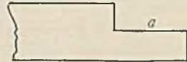
Fig. 8. Längsschnitt durch ein Strichmeter nach Kater . Der begrenzen Strich befindet sich bei a .
