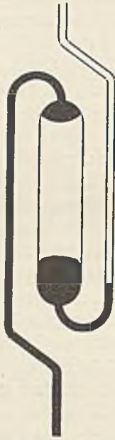
Fig. 70. Einrichtung zur Abtrennung von Quecksilber von dem Faden von Beckmann -Thermometern.
