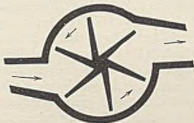
Fig. 32. Schematischer Querschnitt durch einen Flügelrad-Wassermesser.
