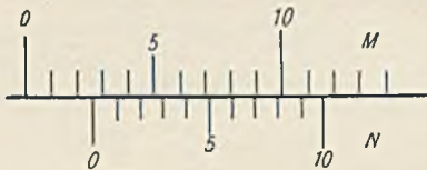
Fig. 21. Zehnteiliger Nonius. (M Hauptmaßstab, N Nonius; Lesung 2,6.)
