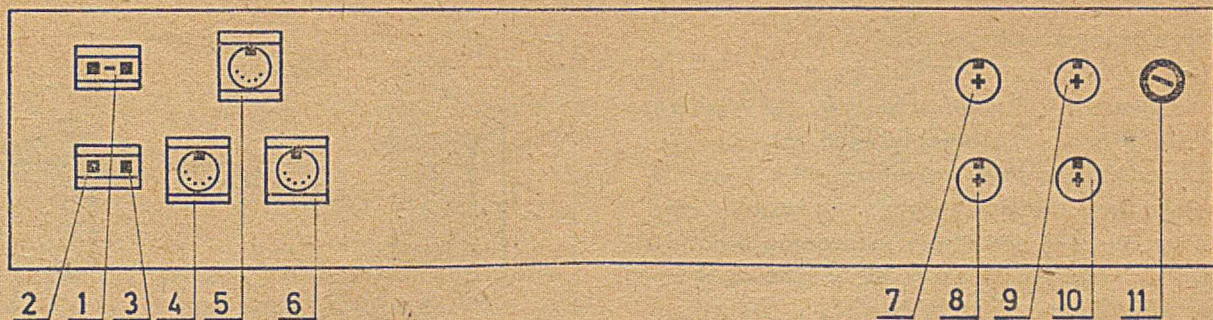
Rys. 2: Rozmieszczenie gniazd przyłączeniowych na ścianie tylnej odbiornika
