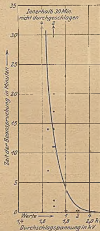
Abb. 1. Versuche bei 50 Per. Abb. 2. Versuche bei 50 000 Per. Abhängigkeit der Durchschlagspannung einer Glimmerfolie von 0,018 mm Stärke von der Zeit der Beanspruchung bei 50 und bei 50 000 Per Wechselspannung.
