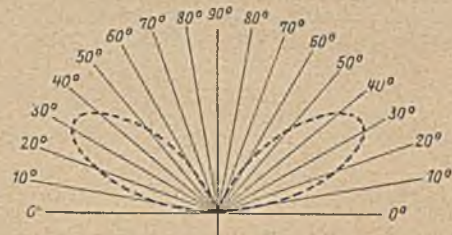
Abb. 10. Vertikales Strahlungsdiagramm einer als \lambda erregten Antenne
