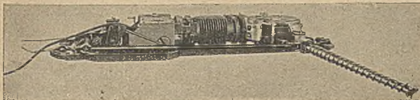
Abb. 3. Stangenschrämmaschine, angetrieben durch den in Abb. 4 dargestellten Motor.
