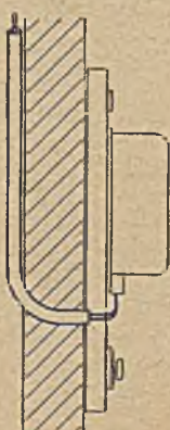
Abb. 2. Rückwärtige Zuführung der Zuleitung.
