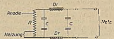
Abb. 2. Prinzip des Gleichstrom-Netzanschlusses.
