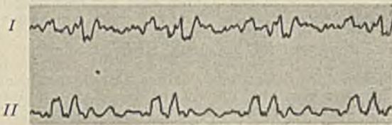
Abb. 5. Vergleich zwischen Kondensatormikrophon (I) und Postmikrophon (II).
