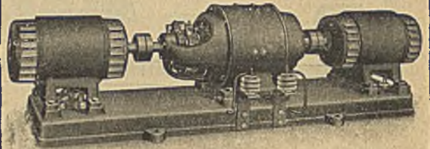
5000 Volt-Aggregat für Großsendestation
