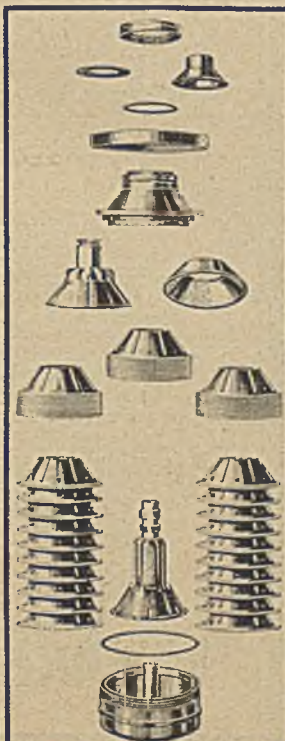
Rotor einer Tellerschleuder abmontiert (60-80 Teile)
