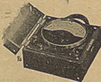
Abb. 749. Voltmeter KX 15 mit 15 cm langer Skala für 3 Meßbereiche
