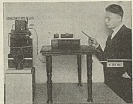
Abb. 3. Ansprechen des Relais durch Näherung entgegengesetzter Ladung.
