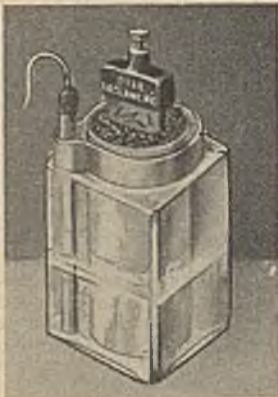
Abb. 1. Leclanché-Element, erste Form.
