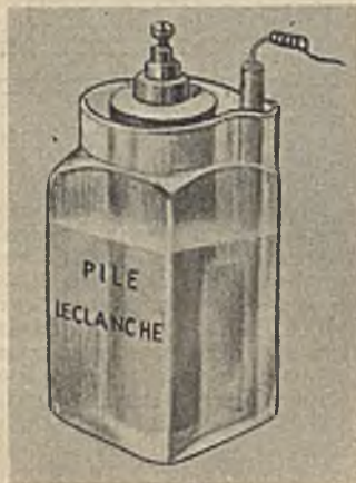
Abb. 2. Leclanché-Element, zweite Form.
