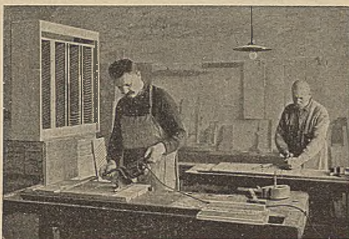
Schneiden von schwalbenschwanzförmigen Nuten.
