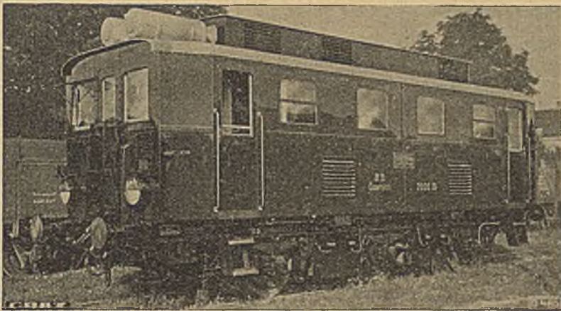
A-1-A Grazer Dieselelektrische Lokomotive Spurweite 1435 mm
