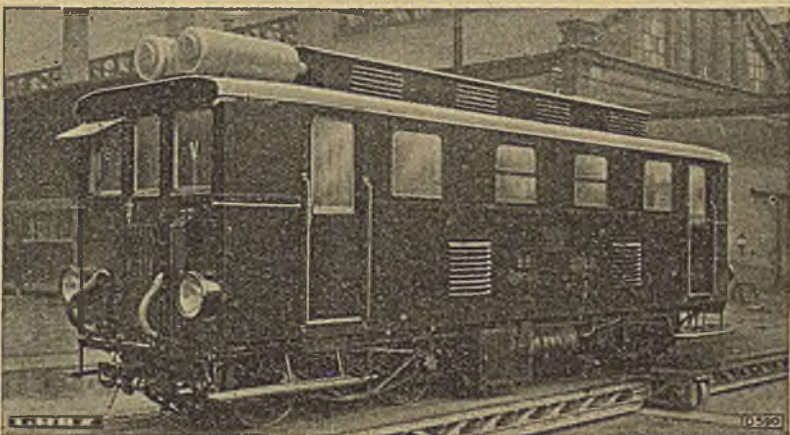
4achsige Grazer Dieselelektrische Lokomotive Spurweite 760 mm
