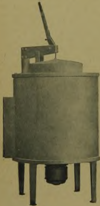
Rys. 16. Piec elektryczny do wyżarzania stopów. (Inż. J. Zubko, Brwinów).
