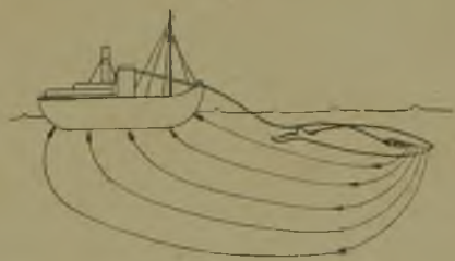
Rys. 1. Schemat obwodu prądu elektrycznego przy połowie wieloryba.
