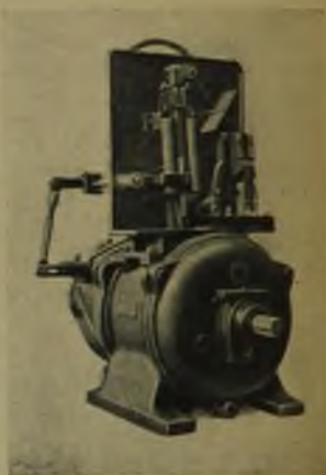
Rys. 4. Silnik jednofazowy z urządzeniem do przestawiania szczotek.
