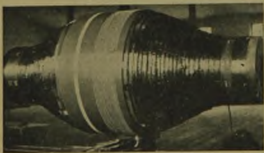
Rys. 2. Cewka do transformatora probierczego 100 kVA, 380/300 000 V (Elektrobudowa).
