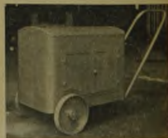
Rys. 4. Transformator do spawania łukiem (Elektrobudowa).
