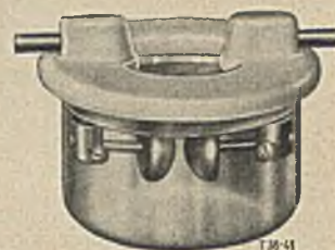
Abb. 6. Ölgefäß mit Prüfelektroden.
