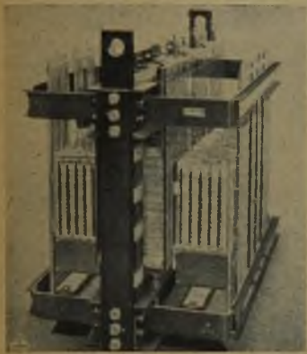
Rys. 3. Trójfazowy transformator syst. Bordoni.
