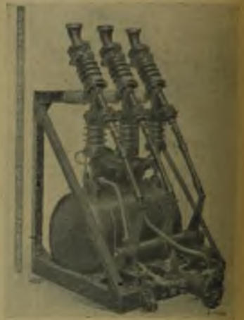
Rys. 3. Wyłącznik na gaz sprężony, 10 kV. (AEG.)
