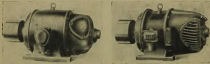
Rys. 8. Silnik asynchroniczny 45 KM (P. T. E.).
