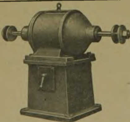
Szlifierka dwutarczowa na niskiej kolumnie, moc 5 KM. 1500 obr.
