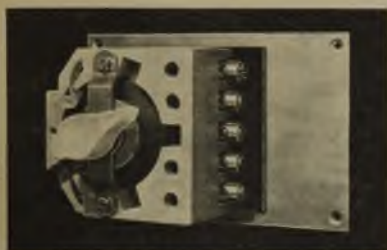
Rys. 3. Przelicznik grzejnikowy na prąd stały i zmienny.
