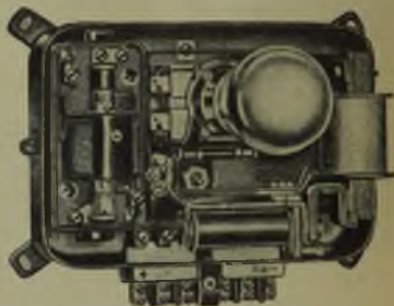
Rys. 9. Przekaznik świetlny w stanie otwartym.
