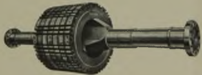
Rys. 1. Widok stalowego korpusu wirnika przed założeniem biegunów.
