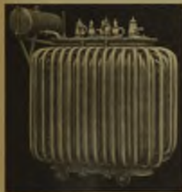
Rys. 8. Każdź transformatora mocy 500 kVA całkowicie cięta i spawana elektrycznie.
