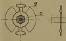
Rys. 17. Sposób osadzenia gwiazdek kontaktowych wylłącznika pakietowego.
