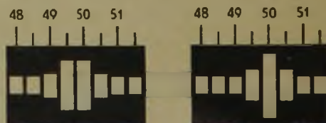
Rys. 50-a. Dwa odczyty na skali częstotliwościarza: „49,75”.
