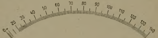
Rys. 43. Skala prawie równomierna uzyskana przez specjalną budowę przyrządu.
