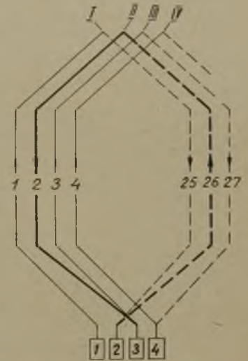
Rys. 2. Wadliwe przyłączenie końców zezwojów do komutatora.
