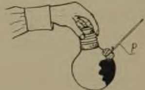
Rys. 4. Matowanie żarówki sposobem gospodarczym.
