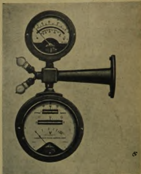
Rys. 17. Przyrządy o obudowie, umożliwiającej zamocowanie na wysięgniku.
