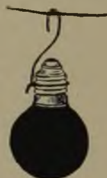
Rys. 5. Żarówka zawieszona po pokryciu bańki kwasem fluorowodorowym.
