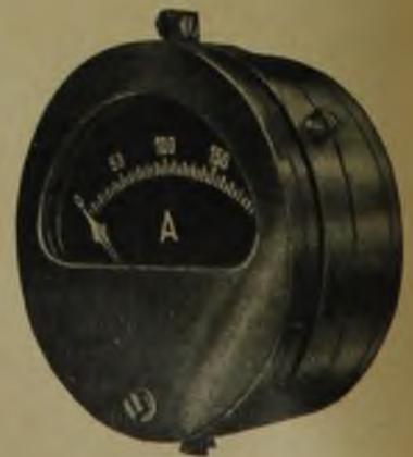
Rys. 18. Widok przyrządu o obudowie całkowicie hermetycznej.
