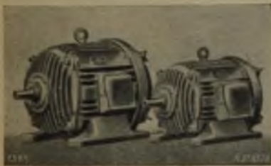
Rys. 2. Silnik trójfazowy żebrowy z chłodzeniem zewnętrznym.
