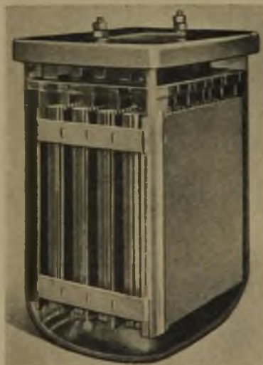
Rys. 3. Mokry kondensator elektrolityczny na niskie napięcie.
