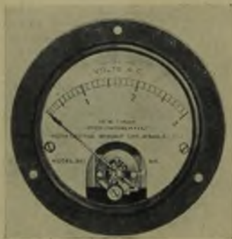
Rys. 2. Woltomierz do wbudowania o średnicy 80 mm.
