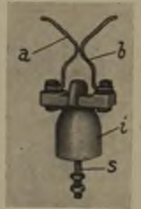
Rys. 2. Odgromnik rożkowy do sieci napowietrznych niskiego napięcia.
