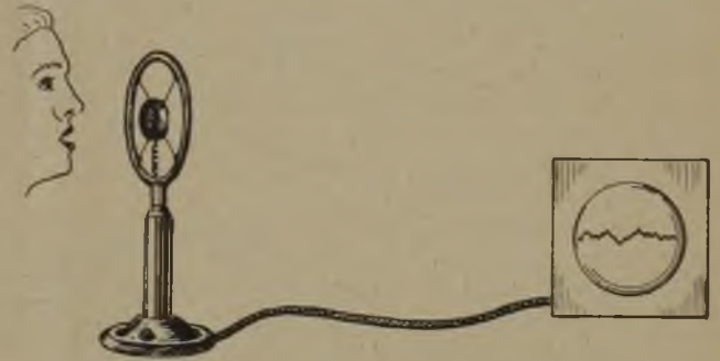
Rys. 15. Wymawiane przed mikrofonem litery wywołują prąd, którego przebieg widoczny jest na oscylografie.
