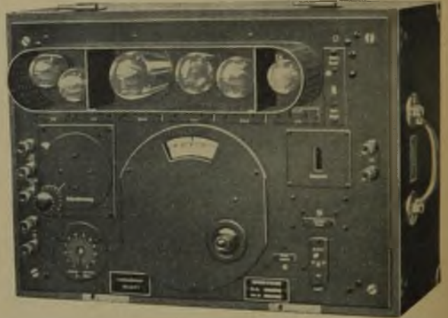
Rys. 12. Generator lampowy dla częstotliwości akustycznych.
