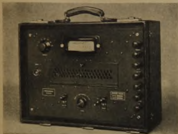
Rys. 5. Widok wzmacniacza wielostopniowego do pomiaru ciśnień akustycznych.
