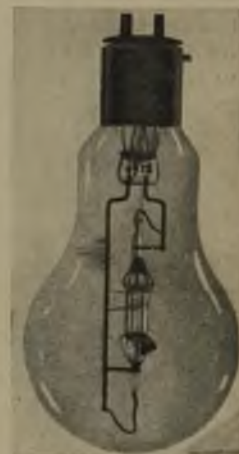
Rys. 2. Lampa rtęciowa, 75-watowa; 3000 lumenów.
