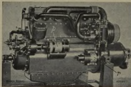
Rys. 18. Widok rozrusznika (r) oraz prądnicy (p) umocowanych na silniku typu Saurer Diesel.
