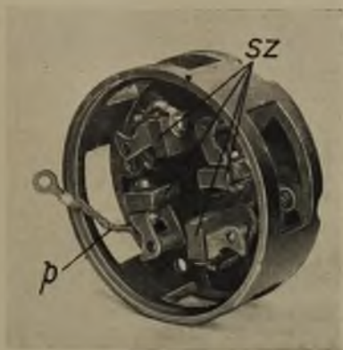
Rys. 16. Widok tarczy łożyskowej rozrusznika samochodowego. p — przewód doprowadzający prąd do trzymadła; sz — szczotki węglowe.
