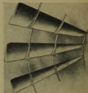
Rys. 45. Sposób powiązania ze sobą łopatek w wirniku silnika „Herkules“.
