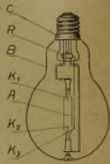
Rys. 18. Poszczególne części składowe lampy rtęciowej typu HP (opis w tekście).
